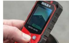
Bei größeren Entfernungen oder schlechten Lichtverhältnissen ist es oftmals schwierig, den Messpunkt genau zu lokalisieren. Dank der Kamera-Funktion lassen sich aber auch diese Messungen leicht durchführen. Mit Hilfe der 2- und 4-fach Zoom Kamera wird über das Display ein spezifischer Zielpunkt genau anvisiert. Ein Knopfdruck genügt und Distanzen bis zu 100 m lassen sich problemlos messen.
